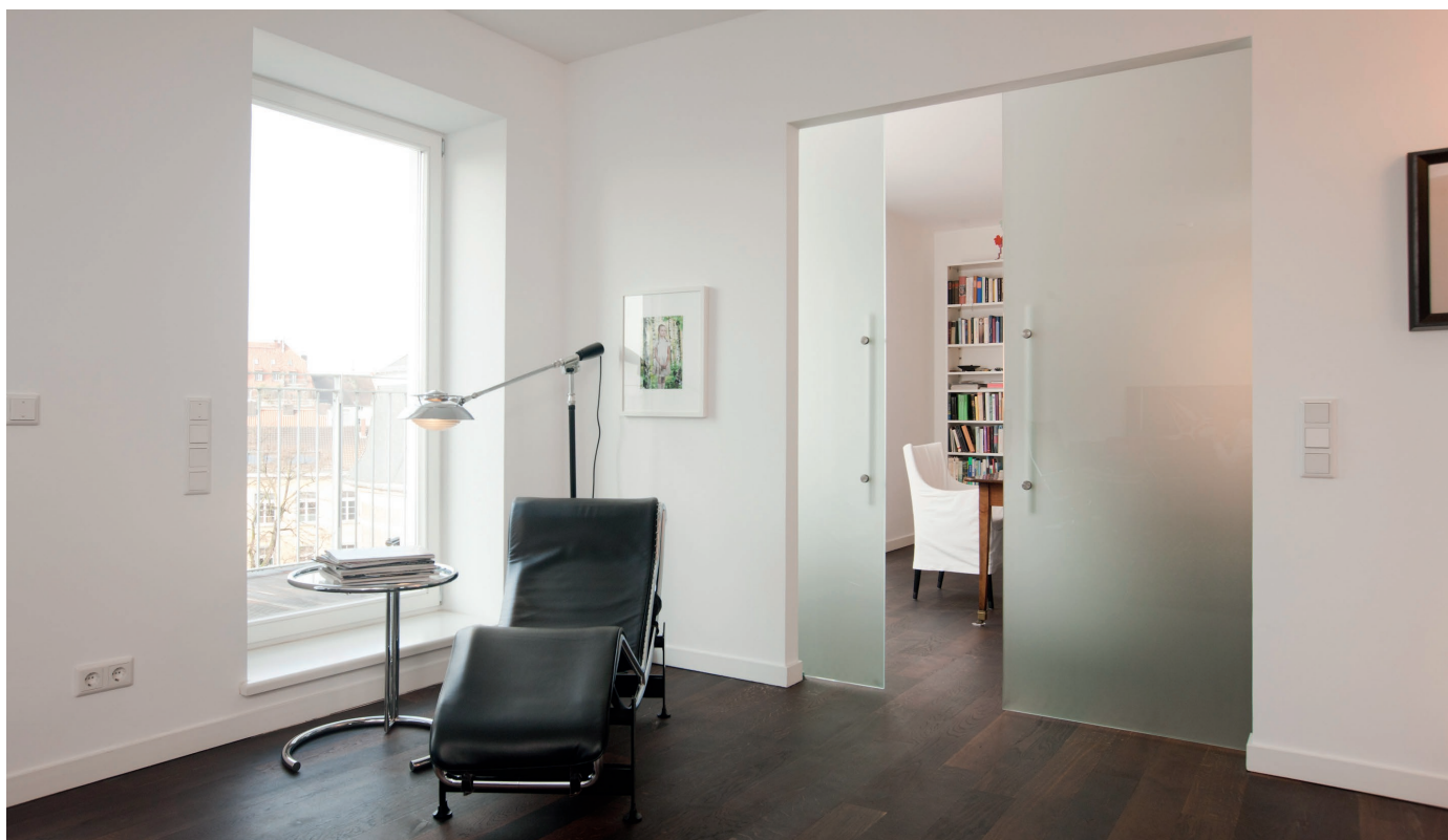
Muto Pocket, drzwi 2 skrzydłowe z pochwytyami jednostronnymi. Szyna jezdna zabudowana płytami g-k. Szkło mleczne.
